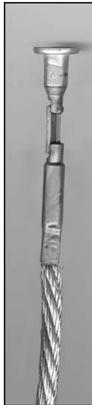
FOTOGRAFIA 2 Fusible T - 140 Amp
