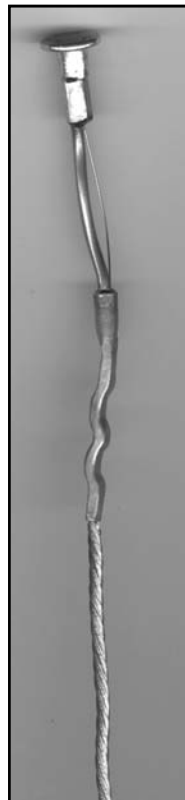
FOTOGRAFIA 1 Fusible T - 30 Amp
