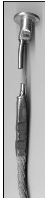
FOTOGRAFIA 8 Fusible T - 65 Amp
