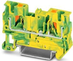
Borna de tierra, número de conexiones: 2, tipo de conexión: Conexión push-in, sección: 0,2 mm<sup>2</sup> - 6 mm<sup>2</sup>, clase de montaje: NS 35/7,5, NS 35/15, color: amarillo-verde
