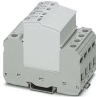
Descargador de sobretensiones enchufable según el tipo 2/clase II, para redes de alimentación de corriente trifásicas con N y PE separados (sistema de 5 conductores: L1, L2, L3, N, PE), con contacto de indicación remota.
