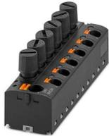
Bloque para distribución, tipo de fusible: G/5 x 20, tensión nominal: 250 V, corriente nominal: 6,3 A, tipo de conexión: Conexión push-in, Derivación, Sección de dimensionamiento: 4 mm<sup>2</sup>, sección: 0,2 mm<sup>2</sup>- 6 mm<sup>2</sup>, tipo de conexión: Conexión push-in, Conexión colectiva, Sección de dimensionamiento: 10 mm<sup>2</sup>, sección: 0,5 mm<sup>2</sup>- 16 mm<sup>2</sup>, clase de montaje: enclavar en adaptador para carril, Montaje directo con una brida, color: negro
