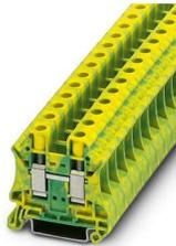
Borna de tierra, número de conexiones: 2, tipo de conexión: Conexión por tornillo, Sección de dimensionamiento: 10 mm<sup>2</sup>, sección: 0,5 mm<sup>2</sup> - 16 mm<sup>2</sup>, clase de montaje: NS 35/7,5, NS 35/15, color: amarillo-verde
