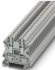
Borne de paso, tensión nominal: 1000 V, corriente nominal: 32 A, número de conexiones: 2, tipo de conexión: Conexión por tornillo, Sección de dimensionamiento: 4 mm<sup>2</sup>, sección: 0,14 mm<sup>2</sup> - 6 mm<sup>2</sup>, clase de montaje: NS 35/7,5, NS 35/15, color: gris
