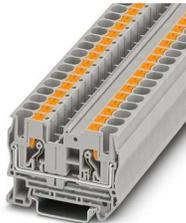
Borne de paso, tensión nominal: 1000 V, corriente nominal: 41 A, número de conexiones: 2, número de polos: 1, tipo de conexión: Conexión push-in, Sección de dimensionamiento: 6 mm<sup>2</sup>, sección: 0,5 mm<sup>2</sup> - 10 mm<sup>2</sup>, clase de montaje: NS 35/7,5, NS 35/15, color: gris
