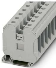
Borne de paso, tensión nominal: 1000 V, corriente nominal: 125 A, número de conexiones: 2, tipo de conexión: Conexión por tornillo, Sección de dimensionamiento: 35 mm<sup>2</sup>, sección: 1,5 mm<sup>2</sup> - 50 mm<sup>2</sup>, clase de montaje: NS 35/7,5, NS 35/15, color: gris
