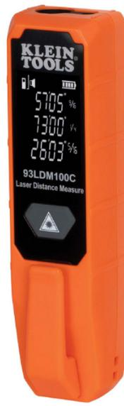
El medidor de distancia láser compacto de Klein Tools proporciona mediciones rápidas y precisas hasta 100' (30,5 m) con una precisión de 1/8" (0,3 cm) y de 1/16" (0,2 cm) para los primeros 30'. Este compacto diseño cabe en el bolsillo de un chaleco de seguridad o camisa para llevarlo fácilmente en el lugar de trabajo. La unidad guarda automáticamente las últimas dos mediciones en la pantalla LCD, lo que permite comparar rápidamente mediciones anteriores.
