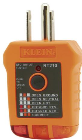
Los probadores de receptáculo de Klein Tools están diseñados para detectar los problemas de cableado más comunes en receptáculos estándar y GFCI. El probador ofrece un cuadro práctico que ayuda a determinar las condiciones de cableado en el tomacorriente en función de los resultados de las luces. Condiciones que indica: puesta a tierra abierta, polaridad inversa, vivo abierto, neutro abierto, vivo/tierra invertidos.
