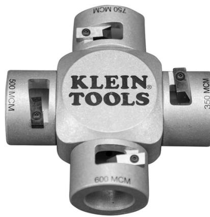
Herramienta rápida y eficaz para quitar el aislamiento de cables MTW/THHN/THWN-2 sin mellar el cable. El diseño tipo trébol ofrece cuatro tamaños diferentes (350, 500, 600 y 750 MCM) en una sola herramienta. Simplemente inserte el cable y gire para lograr un corte preciso y perfecto. El resistente diseño garantiza una herramienta duradera. Pelar cables nunca ha sido más fácil y seguro.
