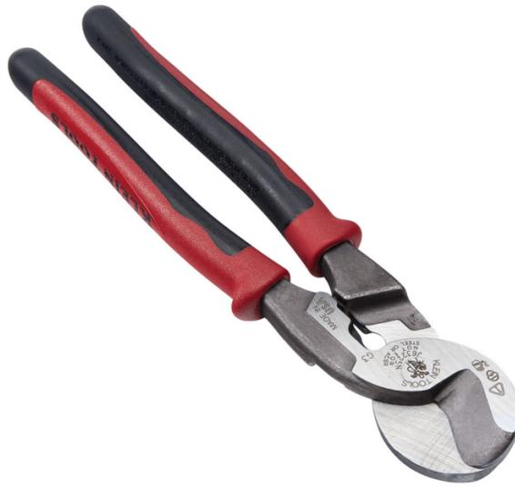
Corte cables de comunicaciones, de aluminio y de cobre con este cortador multicable Journeyman™ de alta palanca. Pele cables de 1/0 y 2/0 con el agujero pelador integrado. Las mordazas tipo cizalla para sujetar el cable y el diseño de alta palanca ofrecen una excepcional capacidad de corte. Los mangos Journeyman™ de doble material proporcionan mejor agarre.
