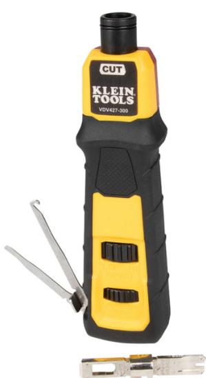
La herramienta ponchadora de impacto de rendimiento de calidad superior proporciona conexiones fiables y siempre precisas. Se usa para ponchar cables de datos en paneles y bloques de 66/110. Termine y corte cables en un solo paso con las cuchillas combinadas 66/110 de moldeo por inyección de metal (MIM) rectificadas a precisión. La herramienta tiene forma con estilo tradicional de ponchado y un mango acojinado y antideslizante.
