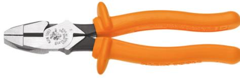
Estas pinzas de corte lateral tipo New England con aislamiento tienen aislamiento de doble capa y cumplen con las normas IEC 60900 y ASTM F1505. Están fabricadas con acero forjado con cuchillas templadas por inducción para ofrecer resistencia y durabilidad. Tienen un diseño de alta palanca que proporciona 46 % más potencia de corte y agarre que otros diseños de pinzas.
