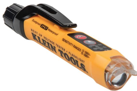
El NCVT-3P es un probador de voltaje sin contacto con linterna incorporada. El sensor de voltaje detecta de 12 a 1000 V CA e indica la presencia de voltaje en cables, cables conductores, cortacircuitos, accesorios de iluminación, interruptores, tomacorrientes y alambres, timbres, termostatos, luces de bajo voltaje y sistemas de riego. Incluye señales visuales y audibles. El NCVT-3P es lo suficientemente resistente para cualquier lugar de trabajo.
