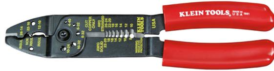
La multiherramienta pelacables de Klein Tools corta, poncha y pela cable sólido y trenzado y corta pernos. Dos cuchillas de corte para cable sólido de 8-22 AWG y cable trenzado de 10-26 AWG. La función de ponchado maneja terminales con y sin aislamiento de 7-8 mm, lengüetas y empalmes.
