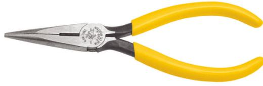
Estas pinzas de punta de corte lateral están fabricadas de acero forjado para brindar mayor durabilidad. La punta larga es ideal para sujetar y enlazar cables. Las cuchillas están templadas por inducción para una larga vida útil. Las mordazas moleteadas permiten enrollar y enlazar cables con seguridad.
